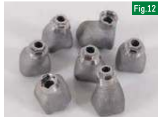
Fig.12 : Chapes pour couronnes implanto-portées imprimées et connectiques rectifiées par usinage (source Z tech, groupe Biotech courtoisie C.Sireix).
