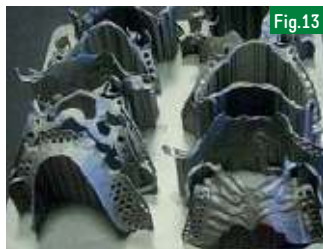
Fig.13 : Châssis pour PAM imprimés par frittage Laser.
