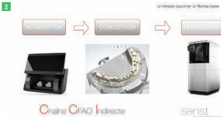
Fig.2 : La CFAO indirecte avec numérisation du modèle en plâtre par un scanner de table puis conception et fabrication de la prothèse, le tout, par le laboratoire. Fig.3 : La CFAO directe avec numérisation de la bouche du patient par empreinte optique, conception puis fabrication de la prothèse au sein du cabinet.
