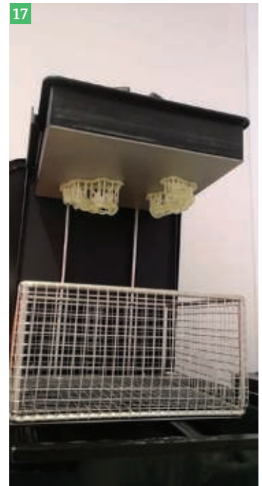
Fig.14 : Modélisation du guide. Fig.15 : Guide modélisé. Fig.16 : Imprimante 3D (Form 2). Fig.17 : Guide en sortie d'impression. Fig.18 : Exemple de guide après stérilisation. Fig.19 : Trousse de chirurgie guidée (Neodent).
