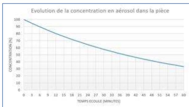
Figure 3 : Évolution de la concentration dans la même pièce, avec une VMC, fenêtre fermée : La seule présence d'une VMC n'est pas suffisante
