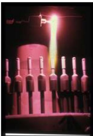
Figure 6-51 : Le dépôt de l'HA se fait à l'aide d'une torche à plasma, dont la très haute température altère la surface du titane. Tant que l'HA est présent, cette calcination du titane n'a aucune conséquence. Dès que l'HA a disparu, l'os se résorbe.
