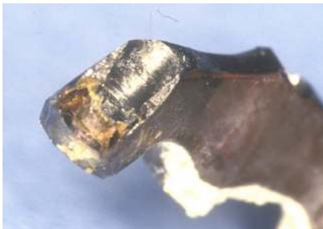
Figures 6-8, 6-7, 6-10 : La réalisation en cire perdue et titane coulé de l'infrastructure d'une prothèse amovible sur implants montre, à la radiographie, de très importantes porosités liées à l'affinité du titane pour l'oxygène. Une fracture de l'armature est intervenue après quelques jours seulement d'utilisation...
