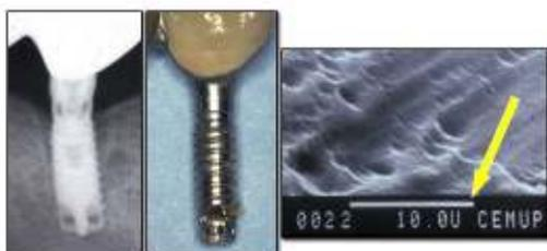
Figure 6-37 : Un implant a été déposé en raison de son absence d'intégration osseuse. Son état de surface est lisse, "poli miroir" comme proposé dans les années 1985-1990. Son analyse au microscope électronique à balayage montre, par rapport à l'échelle de référence (flèche), que les porosités de surface font 2 ou  $3 \mu\text{m}$ , confirmant ainsi les travaux de Olmsteadt (1983).
