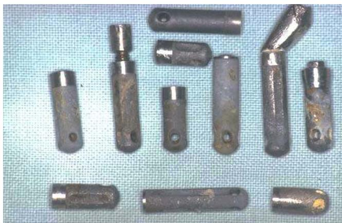
Figure 6-39 : Différents fabricants proposaient des implants recouverts d’HA (Steri-Oss, Calcitek, Bio-Vent). Ces systèmes ont tous montré, à court et moyen terme, des taux d’échecs importants par la dissolution quasi totale du revêtement.
