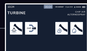
TURBINE LUMIÈRE Réglage de l'intensité de la lumière. Réglage des débits d'air et d'eau des sprays.
