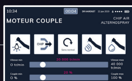
MOTEUR MX À INDUCTION Affichage et présélection de la vitesse des micro-moteurs. Réglage du couple et fonctions auto-reverse et auto-forward.
